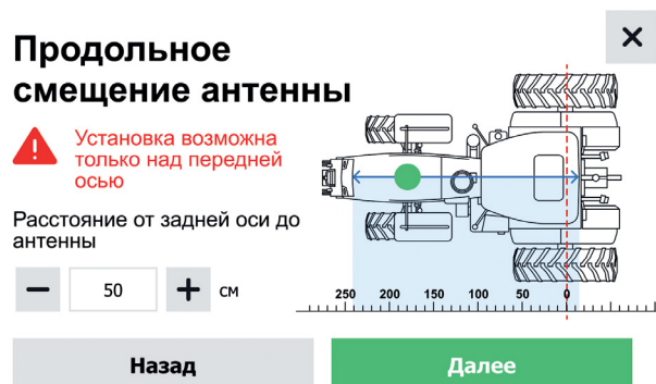
Рисунок 42. Профиль техники. Продольное смещение антенны
