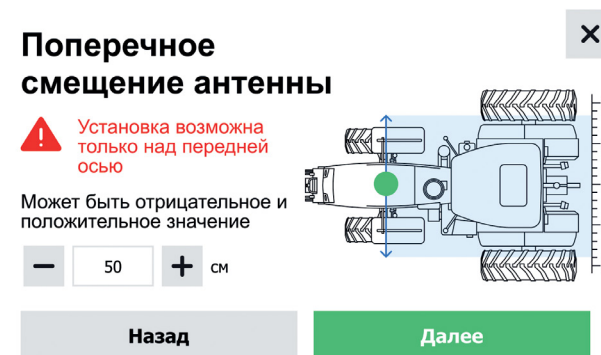
Рисунок 43. Профиль техники. Поперечное смещение антенны
