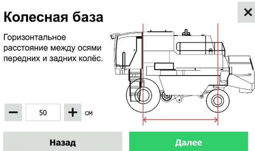
Рисунок 44. Профиль техники. Колесная база
