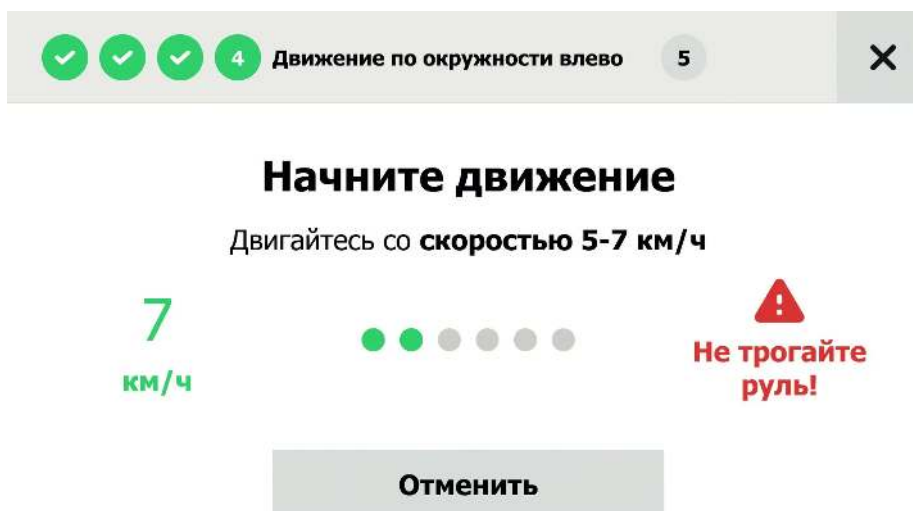
Рисунок 73. Мастер калибровки — Сбор данных при движении по окружности
