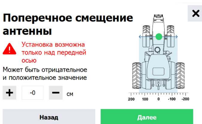
Рисунок 38. Профиль техники. Поперечное смещение антенны
