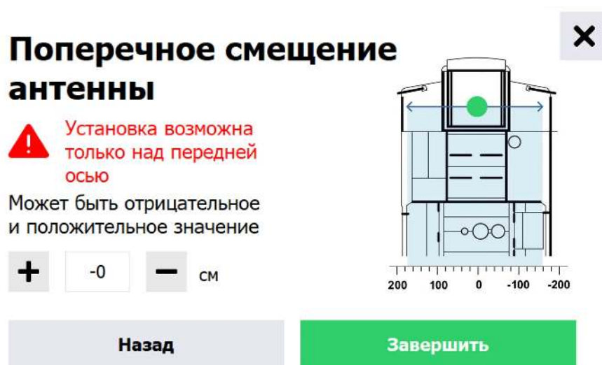
Рисунок 47. Профиль техники. Поперечное смещение антенны
