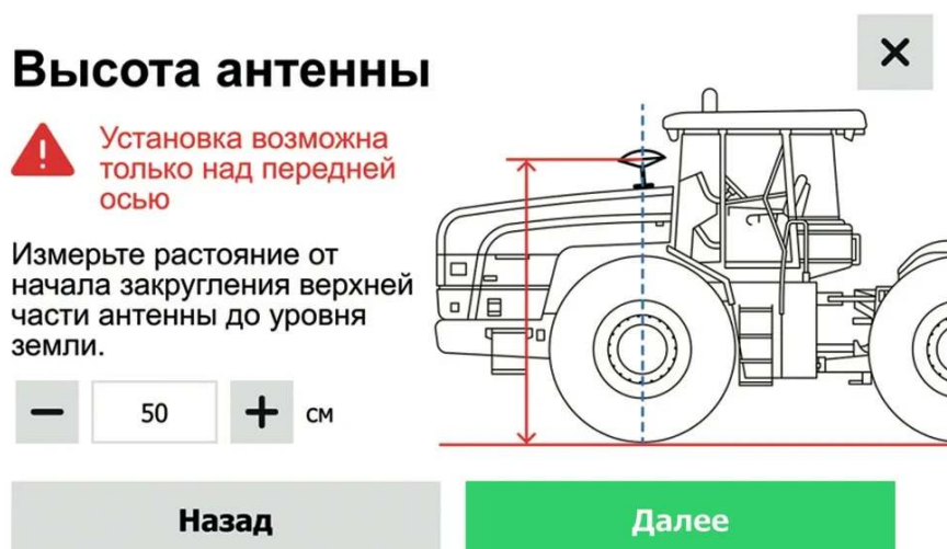
Рисунок 41. Профиль техники. Высота антенны
